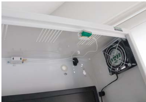
Doppio Microswitch (incluso) e 2 Ventole con termostato (opzionali)
